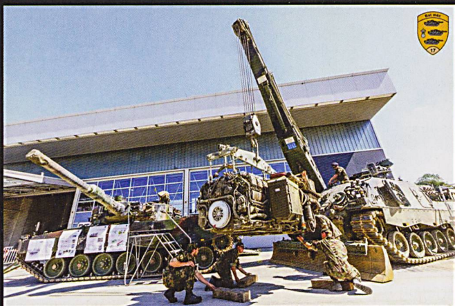
Un char de dépannage Büffel vient de démonter le « powerpack » de 1'500 chevaux du char à côté de lui.
