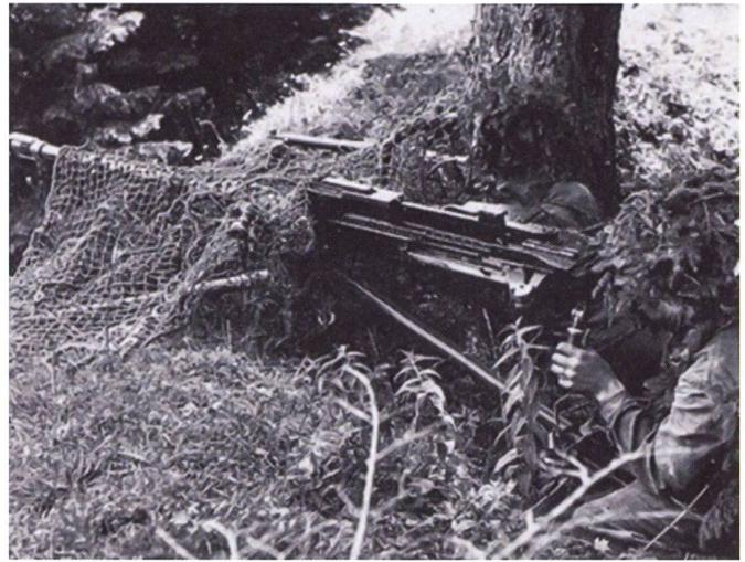
L'arquebuse 41 tire des obus de 20 mm à une distance pouvant dépasser 1'000 mètres. Mais en 1941 elle est déjà largement dépassée en tant qu'arme antichar.
