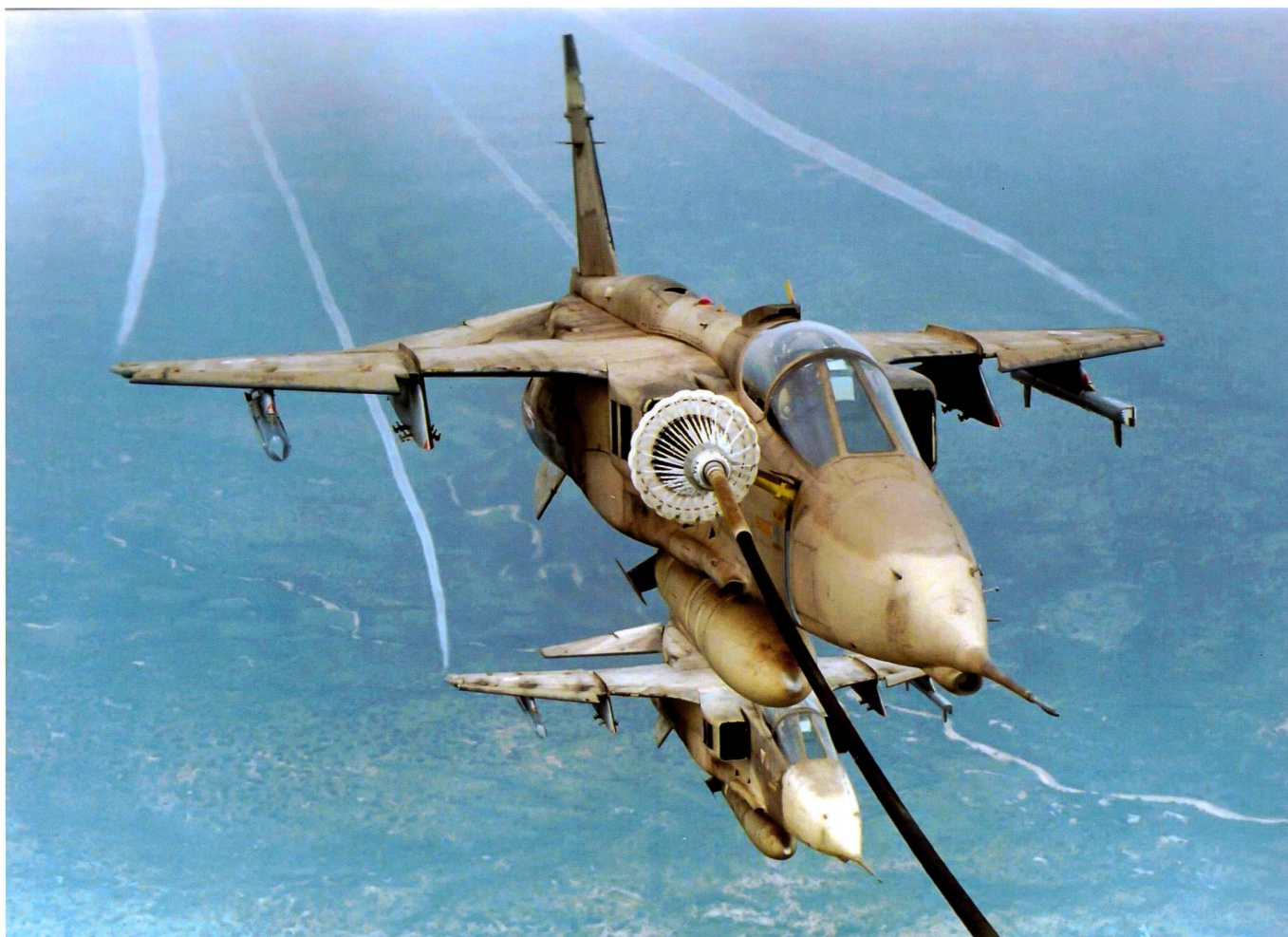
Deux Jaguar A français en livrée « désert » et en train d'être ravitaillés. Ils sont équipés de bidons et de contre-mesures électroniques Phimat et Barax . Le premier permet l'éjection de paillettes (chaff) faisant office de leurres électromagnétiques. Le second est un brouilleur actif. Tous deux ont été étalonnés pour agir en priorité contre les radars à haute fréquence des défenses aériennes tactiques du Pacte de Varsovie.
