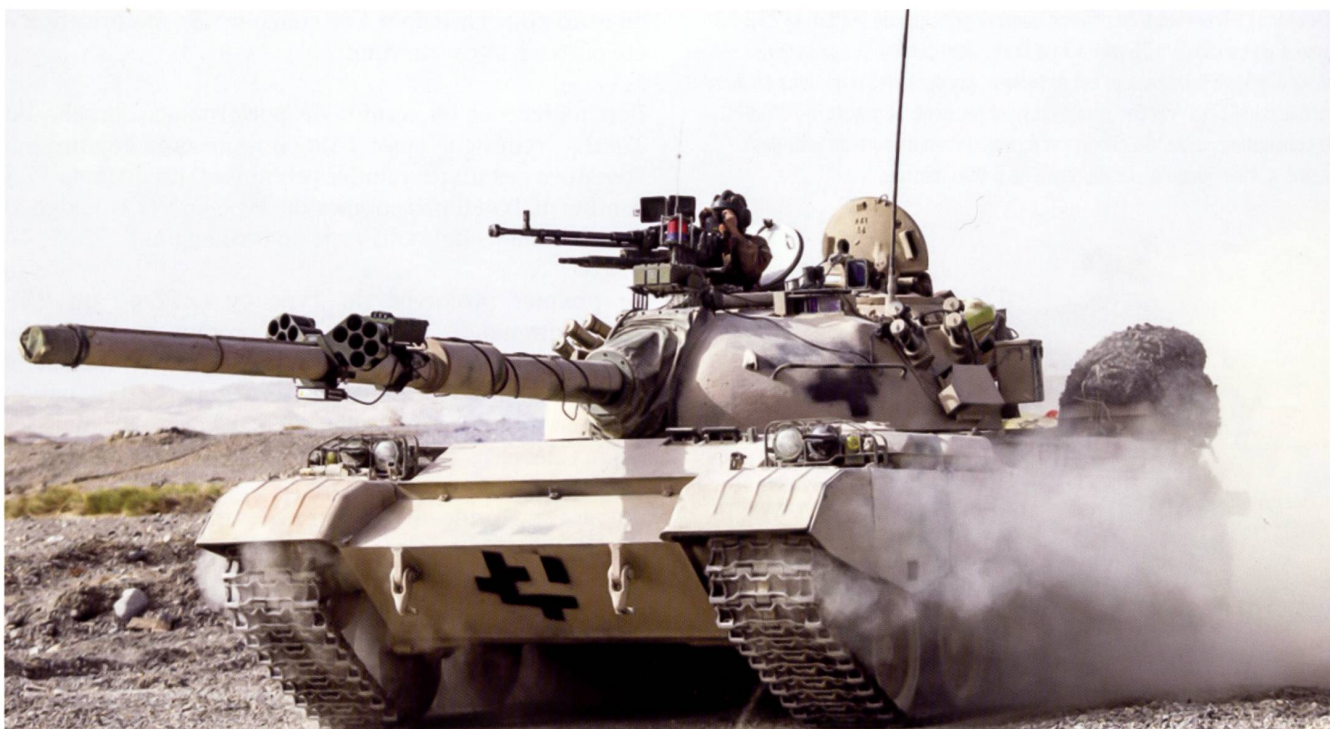
Un char Type 80 disposant de simulateurs de tir laser et d'une électronique occidentale. L'engin est sensiblement plus grand que le T-54 dont il est issu.
