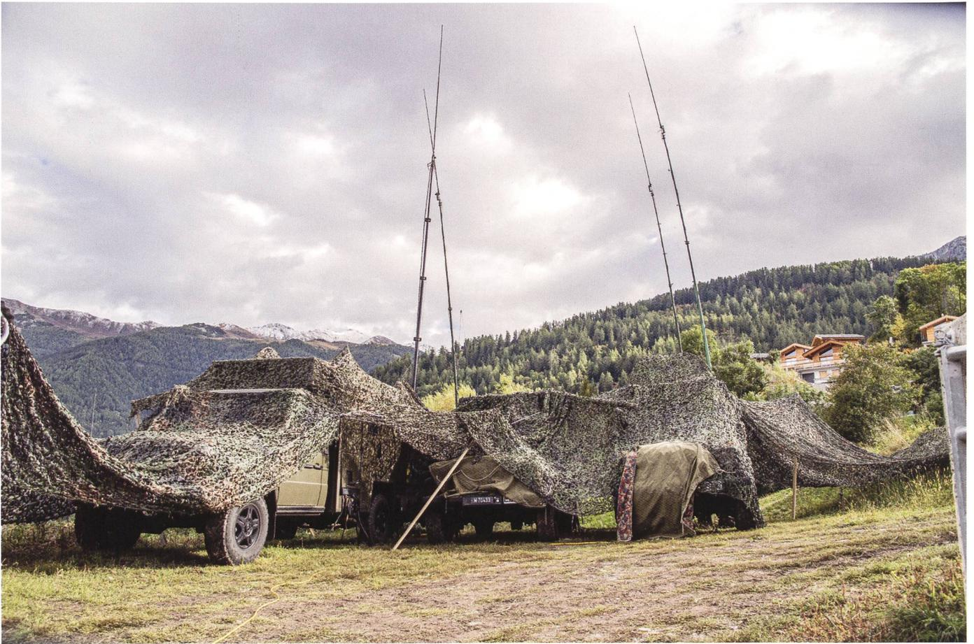
Ci-dessus : Une « ferme d'antennes » permet aux emplacements réels des échelons et postes de commandement d'échapper à l'exploration électronique.
