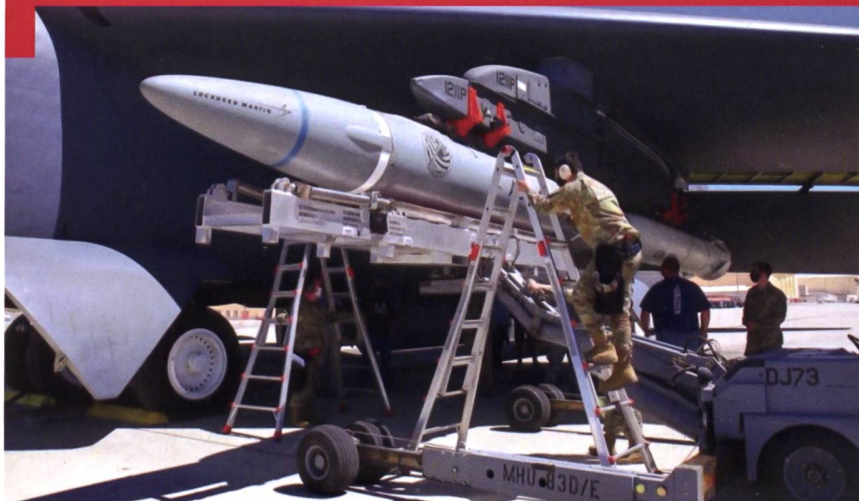
Juin 2019 : Essai de tir du Air-Launched Rapid Response Weapon (ARRW) américain AGM-183, lancé par un B-52. Le missile vole à Mach 5 (6'125 km/h) puis son 2 e étage atteint Mach 20 (24'696 km/h) et peut frapper une cible à 1'600 km de distance. Photo © Lockheed Martin.
