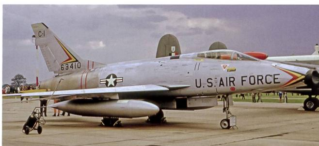
Un F-100D *Super Sabre* du 48 TFW. L'appareil était armé de quatre canons de 20 mm et son radar primitif ne permettait que de mesurer la distance de la cible afin d'ajuster le collimateur. Cet appareil pouvait recevoir une perche de ravitaillement en vol fixe, montée sous l'aile droite. Le F-100 pouvait franchir le mur du son en léger piqué.
