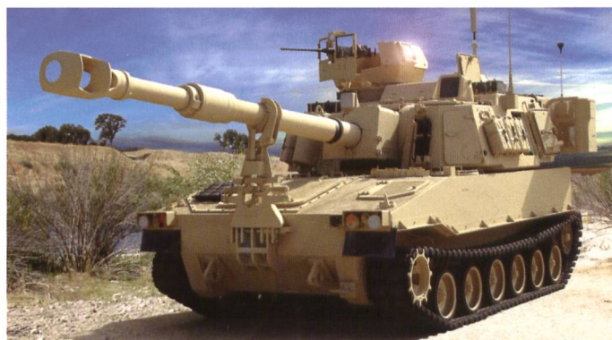
Prototype du M-109A7 disposant de protections supplémentaires, d'un nouveau châssis – identique au M2/M3 – et d'une électronique améliorées.
