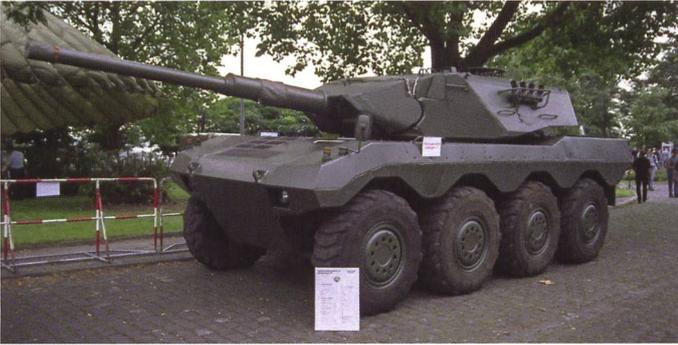
Le prototype du Radpanzer 90 était un concept destiné à adapter la tourelle du *Léopard* 1A3 sur un châssis 8x8 similaire à celui de l'engin de reconnaissance *Luchs*. Trop lourd et trop encombrant, sa mobilité était décevante et il n'a jamais été commandé.
