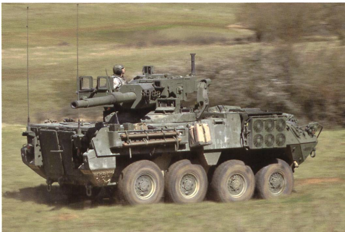
Cette photo illustre bien quelques unes des problématiques de la tourelle téléopérée du MGS : le pointeur recherche des buts à cinq heures et le commandant – qui pourrait pourtant employer le périscope au dessus de la tourelle, grimpe en hauteur pour pouvoir guider son pilote jusqu'à sa prochaine position de feu.
