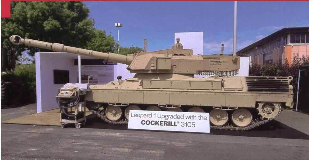
Présentation de la tourelle M3105 sur un châssis de Léopard 1A5 à Eurosatory, en juin 2020. Photo © A+V
