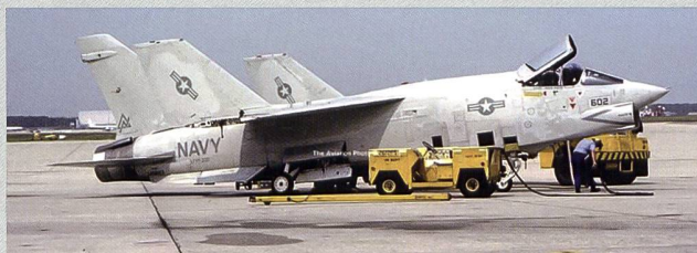
Les lignes caractéristiques du Crusader se retrouvent sur le RF-8 de reconnaissance. Les canons et les pylônes ont été démontés et une batterie de caméras a été installée sous la prise d'air du réacteur.
