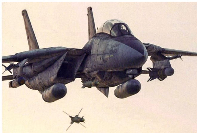
De nombreuses missions lors de la « guerre globale contre le terrorisme » (GWOT) ont vu des F-14D emporter une panoplie d'armements variés : deux bombes guidées, deux missiles AIM-9, la nacelle LANTIRN (sous le pylône droit) et un AIM-54 Phoenix.
