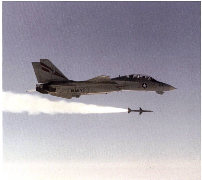
Tir d'un missile à guidage radar semi-actif (SARH) AIM-7E Sparrow . L'appareil appartient au VF-201 Hunters – une escadrille de réserve mise sur pied et à volé sur Phantom puis sur le Tomcat entre 1984 et 1987.
