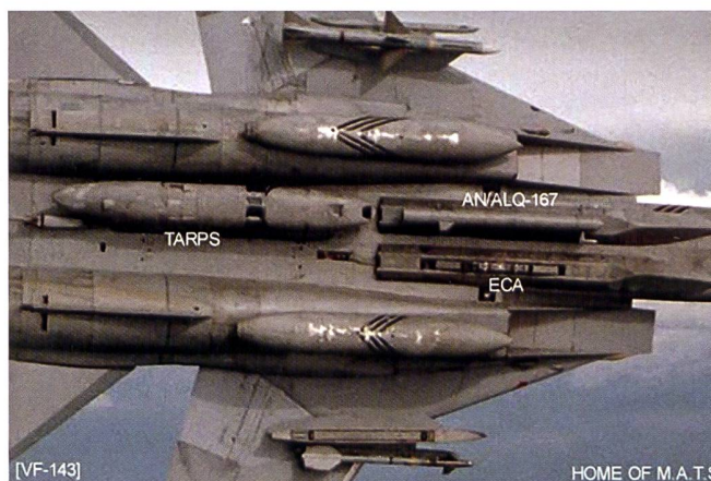
Ci-dessus : La nacelle TARPS, augmentée en fonction des besoins avec des systèmes de brouillage ou d'exploration électronique, a transformé le F-14 en un appareil de reconnaissance aérienne à hautes performances et, pour la première fois, également capable d'être armé et de voler sans escorte.
