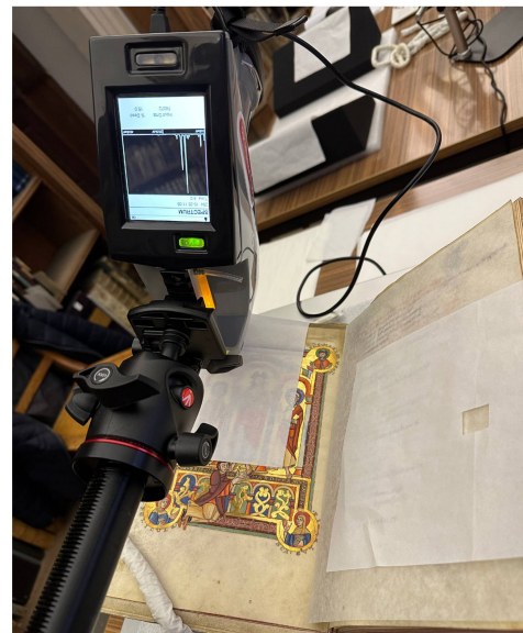
Analyses non destructives au moyen d'un analyseur XRF portable sur les textes sacrés conservés à la Staatsbibliothek de Bamberg.
