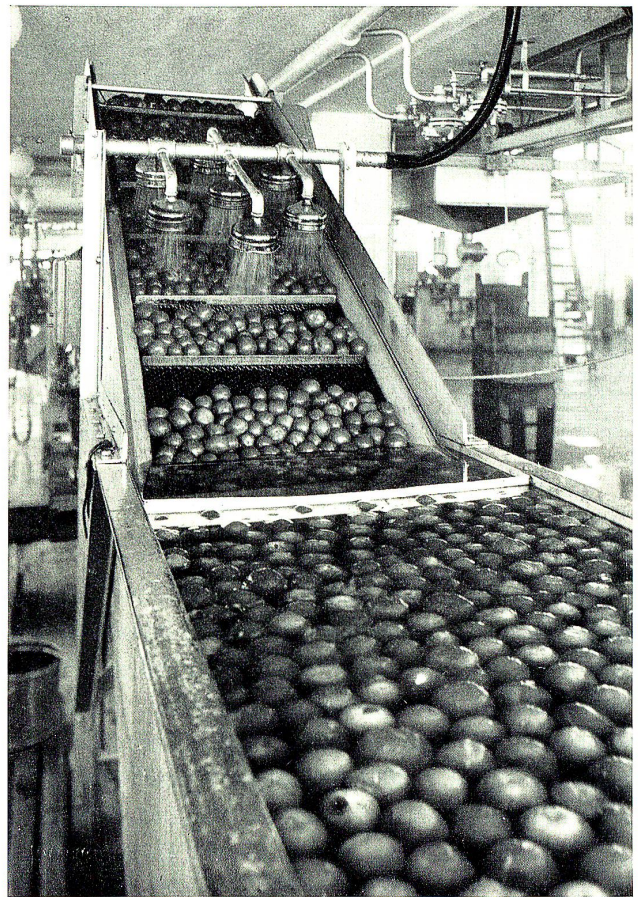
In einer großen, speziell konstruierten Waschmaschine werden hier Tomaten sauber gereinigt
