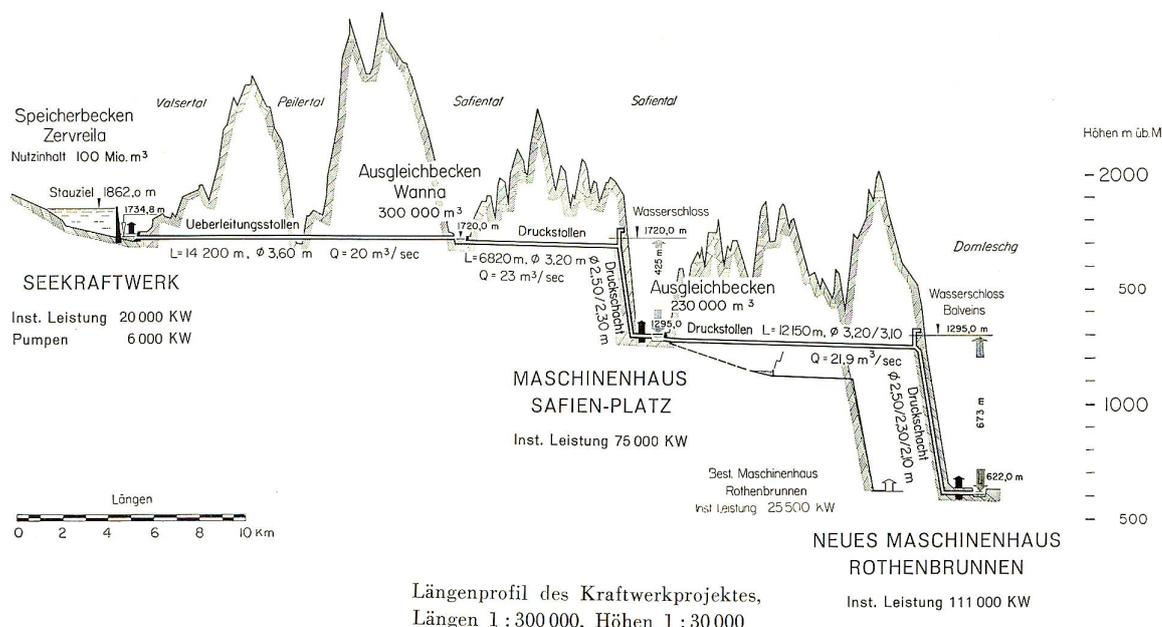
Längsprofil des Kraftwerkprojektes,
