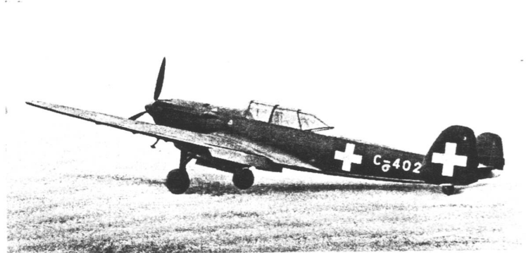
C 3603 Werk : K+W, Thun und Emmen. Baujahr : 1941/42. Material : Ganzmetall. Ruder stoffbespannt. Verwendung : Mehrzweck. Länge : 10,23 m. Höhe : 4,07 m. Spannweite : 13,74 m. Fläche : 26,0 m 2 . Total : 3457 kg. Besatzung : Pilot und Beobachter. 1 S.L.M.-Saurer-Motor. Lizenz Hispano-Suiza zu 1000 PS. 12 Zyl. Escher-Wyss vollautomatischer Verstellpropeller (1848).
