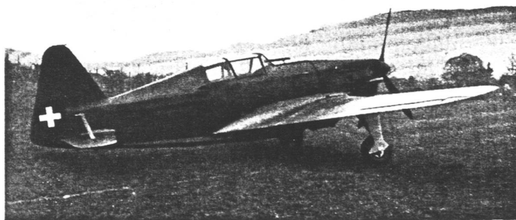
D 3800 Konstrukteur: Liz. Morane. Werk: K+W, Thun u. Emmen. Baujahr: 1939/40. Material: Leichtmetall, Stahl, Stoff, Plimax. Verwendung: Jagd. Länge: 8,17 m. Höhe: 3,25 m. Spannweite: 10,61 m. Inhalt: 16 m 2 . Leer: 1800 kg. Zuladung: 680 kg. Total: 2480 kg. 1 S.L.M.-Saurer-Motor, Lizenz Hispano-Suiza zu 860 PS. 12 Zyl. (1848).
