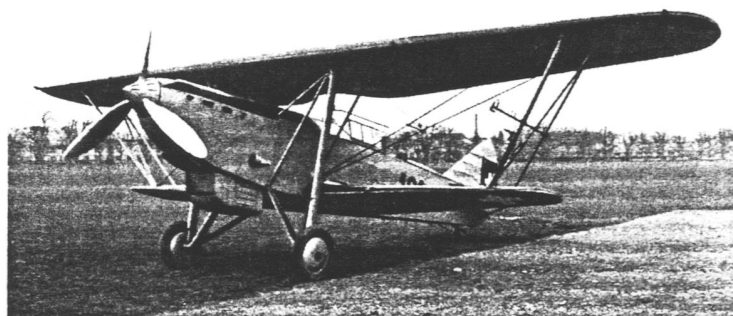
C 35 Konstrukteur: K+W, Thun. Werk: K+W, Thun. Baujahr: 1936. Material: Leichtmetall, Stahl, Holz, Stoff. Verwendung: Mehrzweck. Länge: 9,54 m. Höhe: 3,15 m. Spannweite: 13,08 m. Inhalt: 32 m 2 . Leer: 2000 kg. Zuladung: 1120 kg. Total: 3120 kg. Max.-Geschwindigkeit: 330 km/h. Steigzeit: 1000 m: 2'; 2000 m: 4,1'; 3000 m: 6,25'; 4000 m: 8,5'; 5000 m: 11,75'. Gipfelhöhe: 10 000 m. 1 S.L.M.-Saurer-Motor, Lizenz Hispano-Suiza zu 860 PS. 12 Zyl. (1848).
