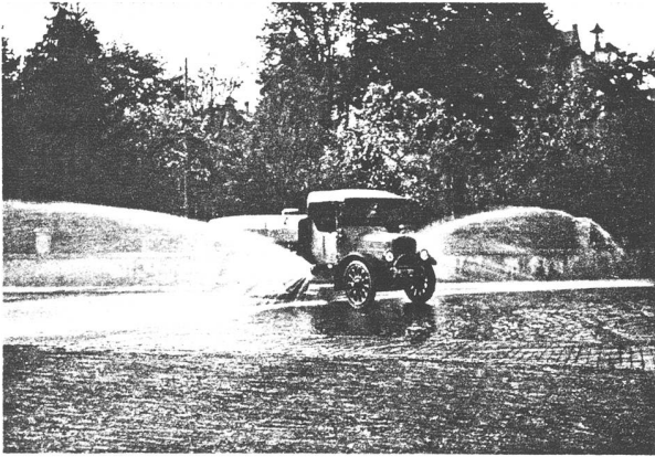
ARROSEUSE AVEC POMPE À PRESSION. SPRENGWAGEN MIT PUMPE. WATERING WAGON WITH PUMP.
