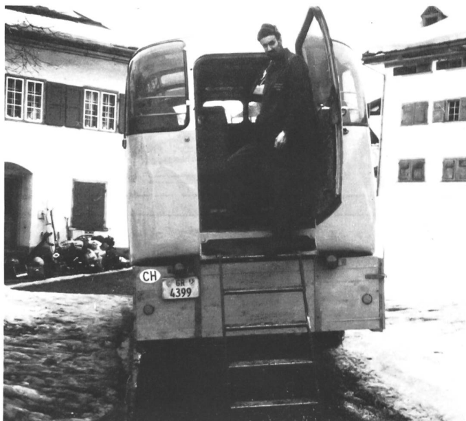
Accès destiné aux passagers; le coffre à bagages et à skis se trouve sous la carrosserie.
