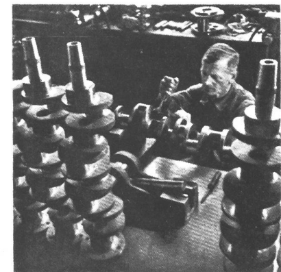
Kurbelwellen: Die Kurbelwellen werden sorgfältig auf ihre Masse kontrolliert und mit den Leitungen für die Oelzirkulation versehen.
