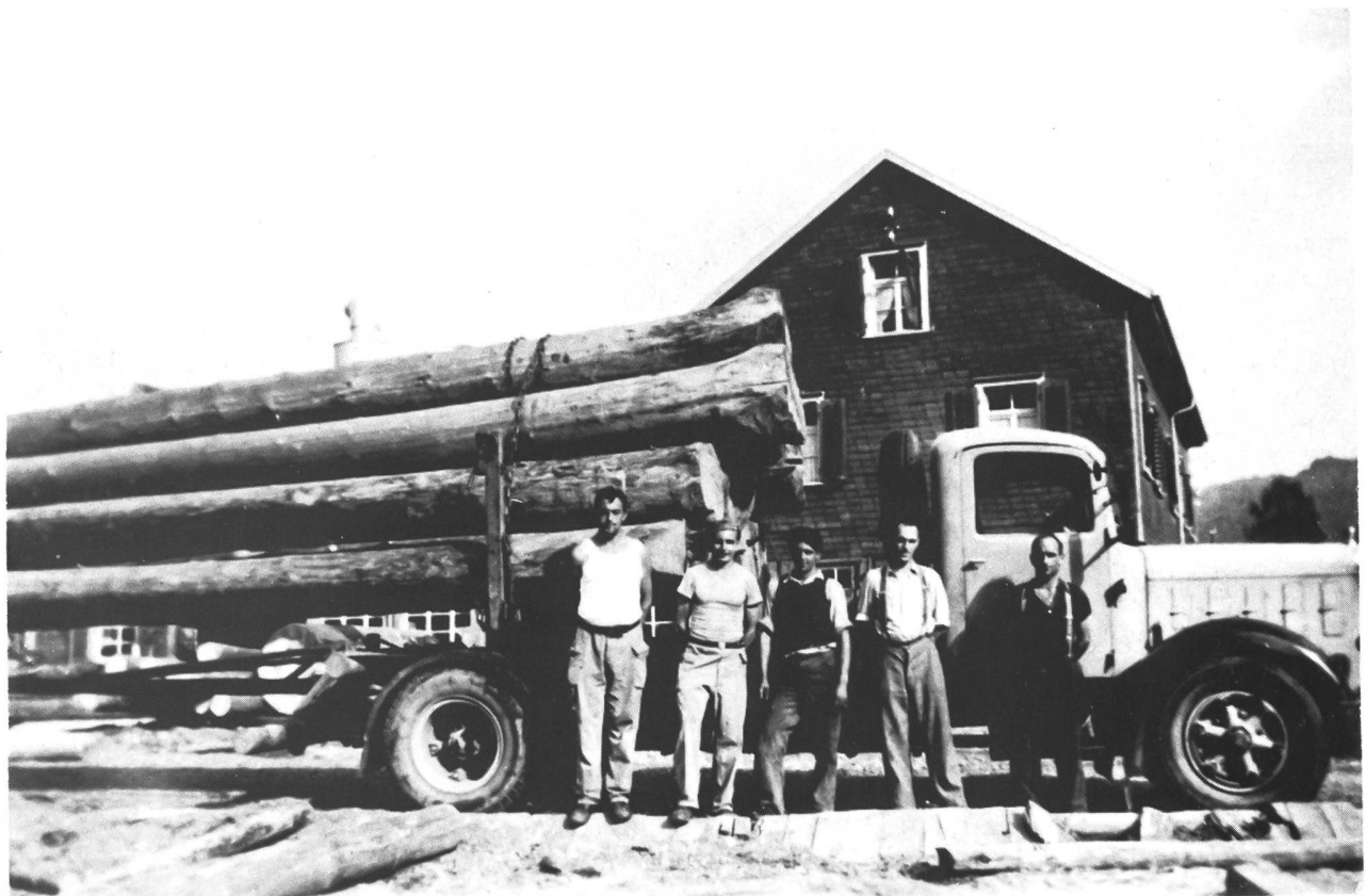
Bild unten. Um die 1949 in Flums. Fahrzeug wieder Berna Jahrg. 36. Besonderes: Erster Selbstlenker konstruiert von Sepp Wespe sen.
