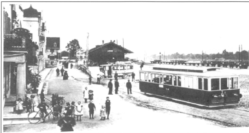
Das Benzin-Tram im Bahnhof Rheineck, dahinter einer der ersten Saurer-Busse der Co. Rheineck-Heiden
