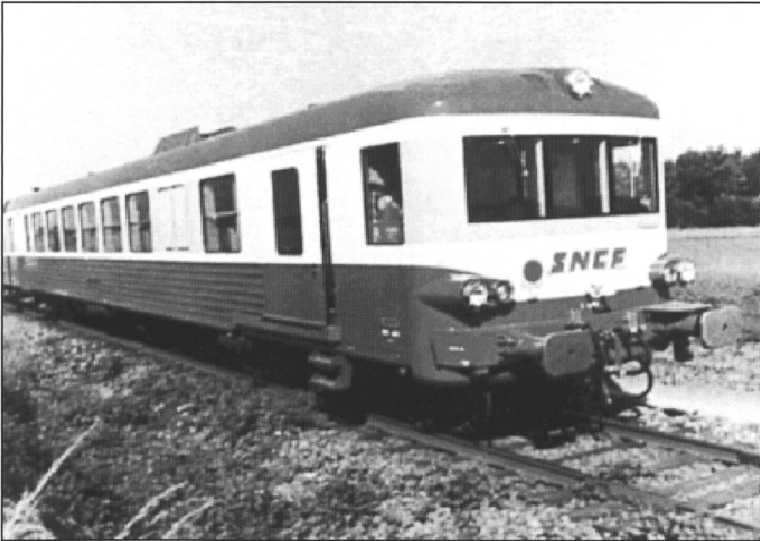
Dieseltriebwagen der SNCF mit 2 x 330 kW
