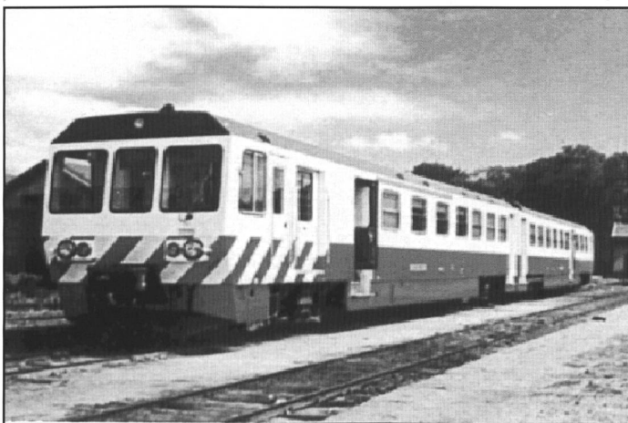
Portugiesischer Dieseltriebwagen mit 1 x 385 kW
