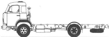
1 Das ist das 5DF/5VF-Chassis mit Kabine. Besondere Merkmale: 16 t Gesamtgewicht, Motorleistung: 250 oder 330 PS (mit Aufladung) nach Wunsch, erhältlich mit 5 verschiedenen Radständen, je nach Einsatz und Verwendungszweck.
