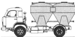
10 Das Buckeln von Zementsäcken gehört längst der Vergangenheit an. In Silos auf 5DF/5VF-Chassis wird der Zement zur Betonaufbereitungsanlage gebracht.
