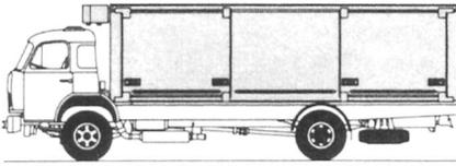
6 Tiefkühltransporter mit eigener Kühlanlage haben den Transport hochverderblicher Nahrungsmittel erst möglich gemacht. Hier sorgt ein solches Fahrzeug auf 5DF/5VF-Chassis dafür, dass die Tiefkühlkette nicht unterbrochen wird.
