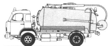
12 Man ist umweltbewusst geworden. Schächte, Benzin und Ölabscheider werden regelmässig ausgesaugt. Dazu braucht man Schlamm- und Öl-saugwagen wie diesen hier auf 5DF/5VF-Chassis.
