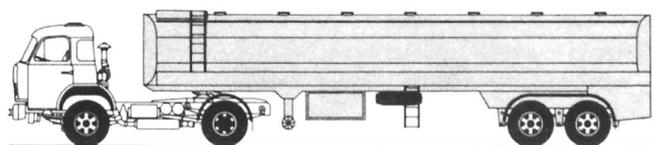
14 Auch Schüttgüter werden heute per Sattelschlepper in Silo-Aufliegern transportiert. Für die nötige Zugkraft sorgt der 5DF/5VF-Schlepper.
