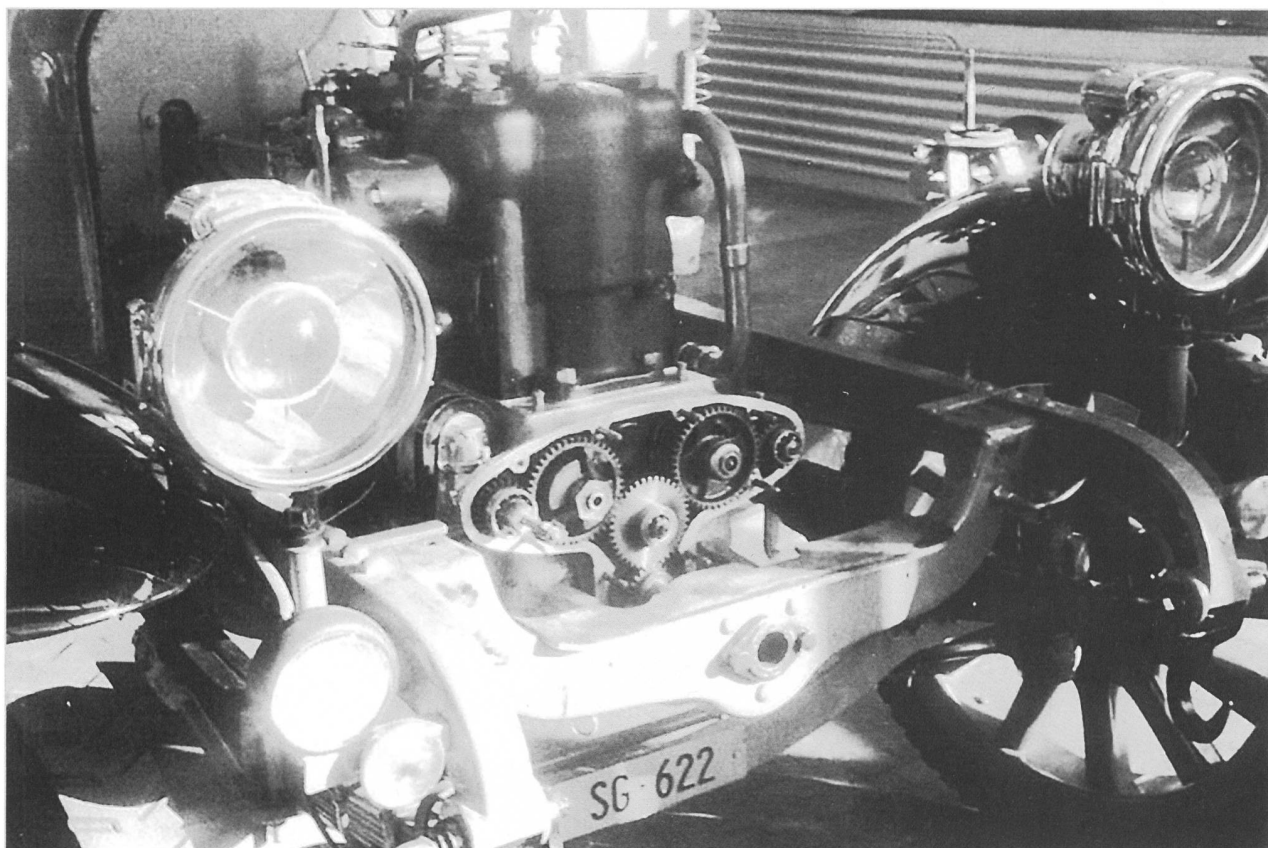
Der Motor mit offenem Nockenwellen Antrieb. 2 Karbidlampen die 1917 schon an diesem Fahrzeug befestigt waren.
