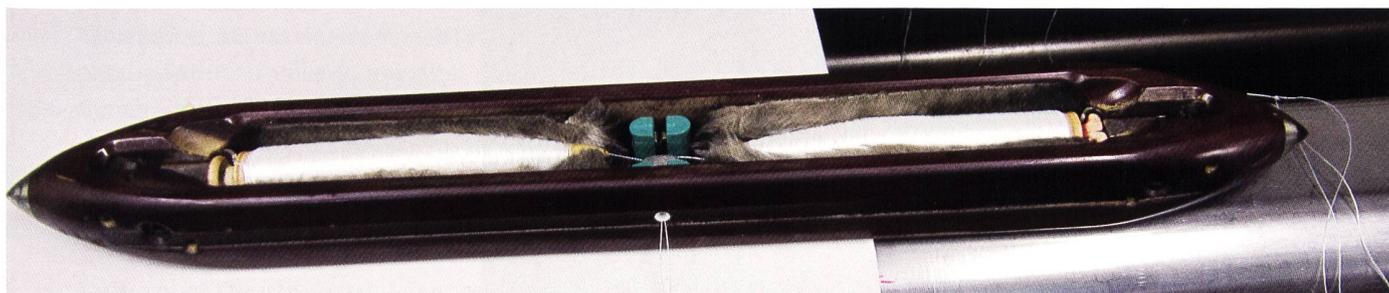
*Der spezielle zweifach bestückte Webschütz («Schiffchen»)*
