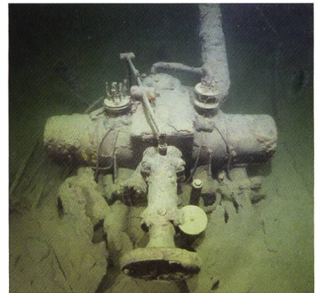
Originalfoto und der Motor im Wrack: beides Saurer Balanciermotoren Typ B II oder B III
