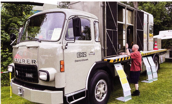
Eine ganz unglaubliche Maschine: Ein Netzausfallersatzgerät, früher Notstromaggregat genannt, auf einem wunderschönen Saurer D230. «Wie neu» ist hier sicher zu Recht angebracht, hat doch das Trägerfahrzeug nur rund 40'000 km auf dem Buckel. Antrieb des Generators für einmal kein Saurer-Stationärmotor, sondern eine Gasturbine. Ein extraordinäres Gespann, das von einer 750 PS-CENTRAX-Gasturbine angetrieben wird. Der Eigner, Thomas Schlumpf, vor seinem Fahrzeug. (Grossaufnahme auf Rückseite der Gazette)
