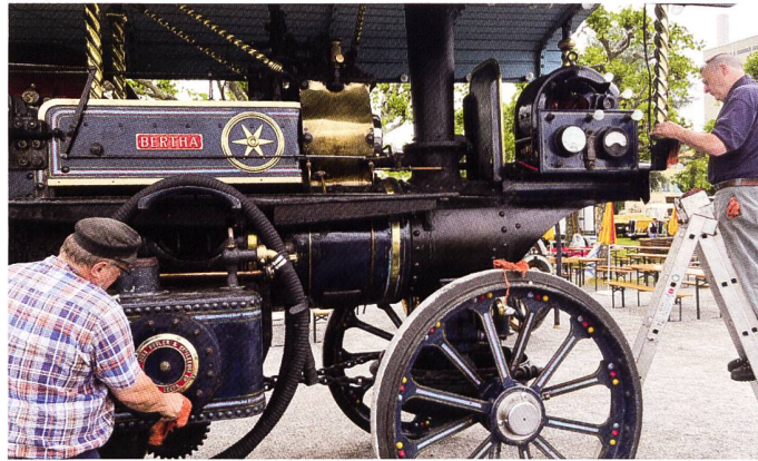
Ein Exemplar für die vielen wunderbaren Objekte, hier eine Strassenmaschine, die nicht nur fahren, sondern auch noch Strom für die Kirmes-Beleuchtung produzieren kann.
