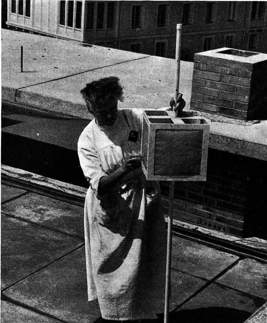
Abb. 1. Vertikal nach den vier Haupthimmelsrichtungen exponierte Staubfangfolien.
