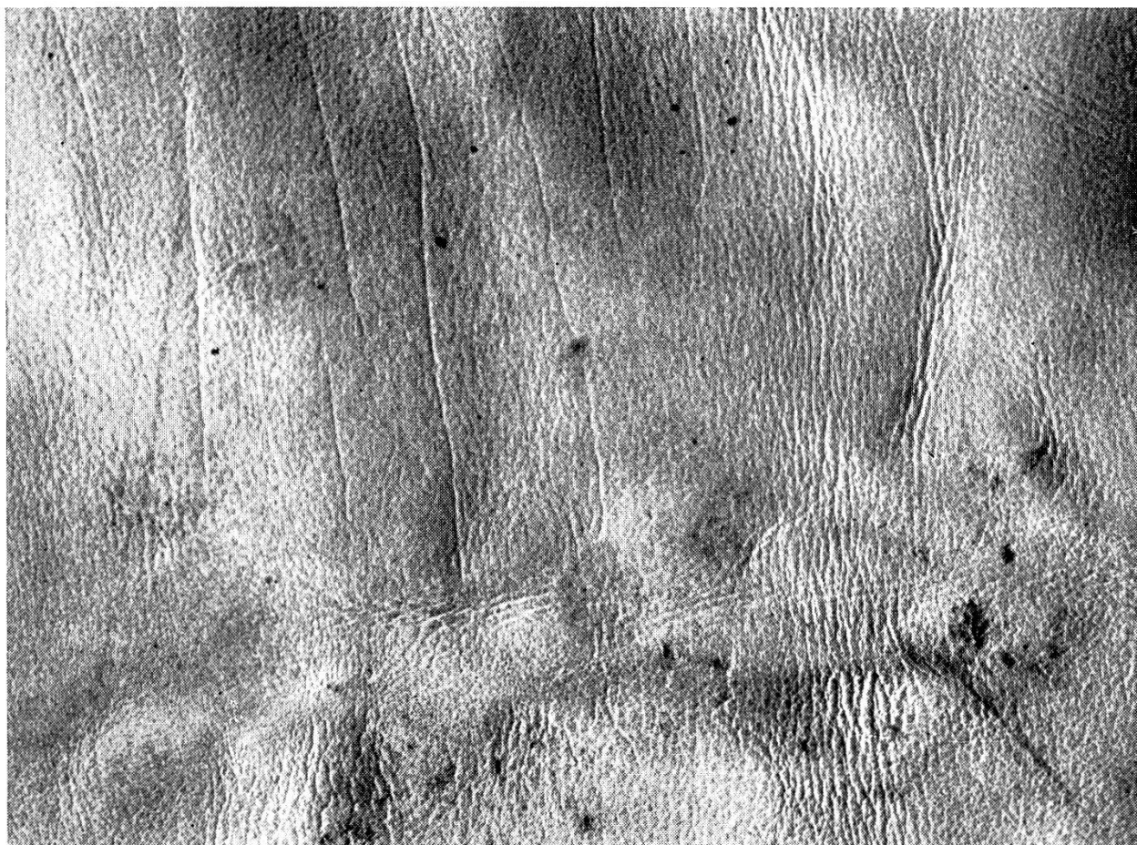
Fig. 8. Lésions sur un cuir tanné de veau, provoquées naturellement par les mallophages d'une part et d'autre part par le poussoir électrique (Brûlures punctiformes).
