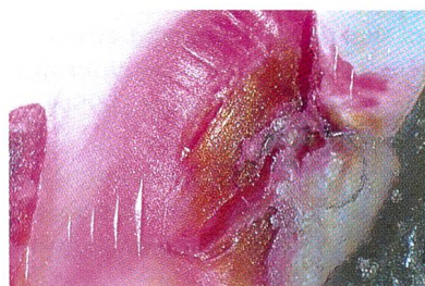
Abbildung 4: Menschlicher Molar mit einer Zahnbalskaries. Die Eindrücke, die durch den Knoop-Diamanten verursacht wurden und bezüglich Länge und Tiefe in Richtung Läsion zunehmen, illustrieren die zunehmende Erweichung des kariösen Gewebes auf Grund des unterschiedlichen Mineralisierungsgrades.
