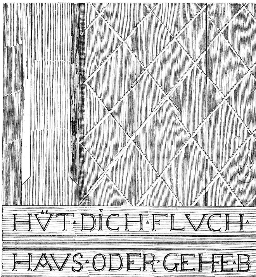
Sog. „Schnürpfverzierung“ an einer rohen Bretterwand (Haus „niclaus rot 1733“ in Dotzingen bei Büren).
