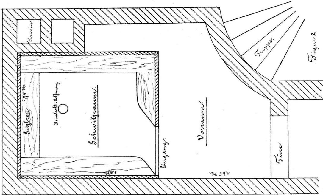
Fig. 2. Grundriss einer zweiten Schwitzstube in Adetswil.
