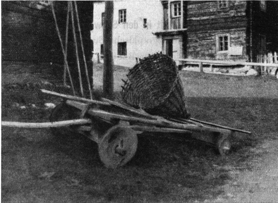
Abb. 20. Handwagen für die Heubündel aus dem Val di Livigno; man beachte die ungleichgrossen Radscheiben für die Steilhänge. Photo A. Brockmann.
