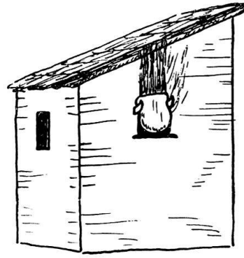
Fig. 5 - Cucina di maggengo separata dagli altri stabili, con foro laterale per l'uscita del fumo.
