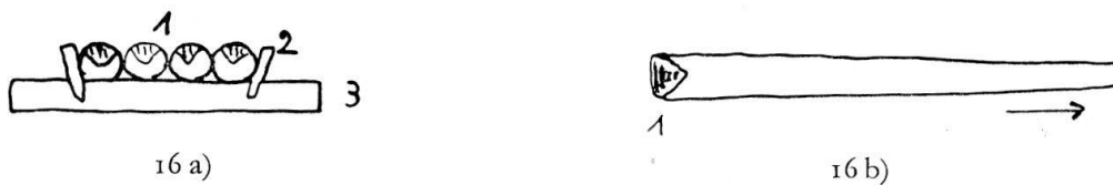
Abb. 16. Ohrenries im Val Sampuoir. 1. Laufer mit Ausbuchtungen (Ohren) im dicken Stirnholzstück, worin das dünne Ende des oberen Läufers aufliegt. 2. Holznägel 20–25 cm lang, 15–25 mm dick. 3. Bockbaum, alle 5 m ein Stück.
