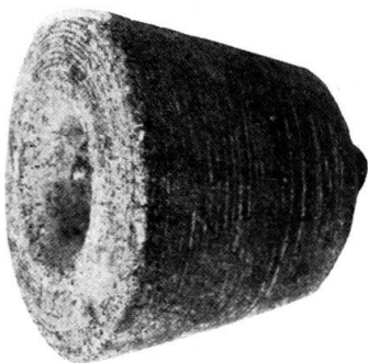
Abb. 8. Als Rest von der innersten Schüssel bleibt noch der Kern. Vorn die zuerst eingedrehte Zentrierung und hinten der abgebrochene Zapfen.
