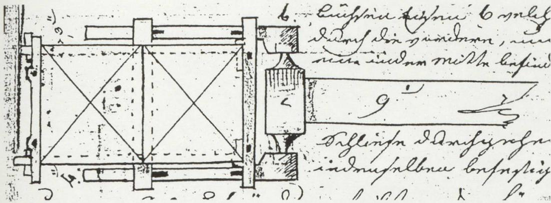
Abb. 5 Balkengerüst des Aufwerfhammers, Aufsicht von oben
