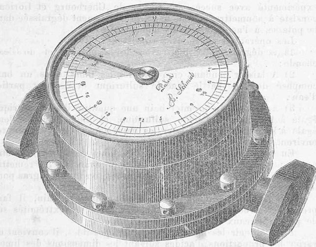
Dieser Flüssigkeitsmesser besteht im Wesentlichen aus zwei unter einem rechten Winkel zusammengekuppelten hydraulischen Maschinen, bekannt unter dem Namen „Schmid's Wassermotoren“, welche in einem wasserdichten Gehäuse eingeschlossen, von der zu messenden, unter einem gewissen Drucke befindlichen Flüssigkeit in Bewegung gesetzt werden.
