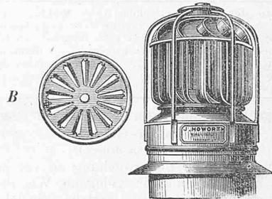
des Hutes von Aussen, B die Schiebklappe an der Wagendecke, von Innen gesehen, darstellt. Letztere wird je nach Bedürfniss geöffnet oder geschlossen.
