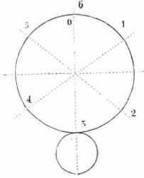
stehen eines Tellerventils der Raum unter dem Kolben mit demjenigen über demselben. In (6) angelangt, hat der atmosphärische Cylinder-Kolben die 6 Touren gemacht, das Vacuum ist ausgenützt und das Spiel beginnt von Neuem.
