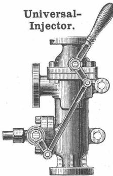
**Körting's Patent-Universal-Injectoren und Speisewasser-Vorwärmer.** Kostenerparnis durchschnittlich 10%. Grösste Einfachheit und Betriebssicherheit. Saughöhe 7 m. Maximaltemperatur 70° C.
