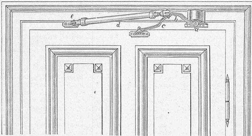
In neuerer Zeit ist nun ein *pneumatischer* Apparat construir worden, der diese *Uebelstände* beseitigt. — Dieser sog. *pneumatische Thürzuschlag-Hinderer* vereinigt folgende *Vorzüge*:
