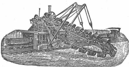
**Excavatoren (Trockenbagger)** zum **Eisenbahn- und Wasserbau**, für Abträge und Einschnitte, zum
