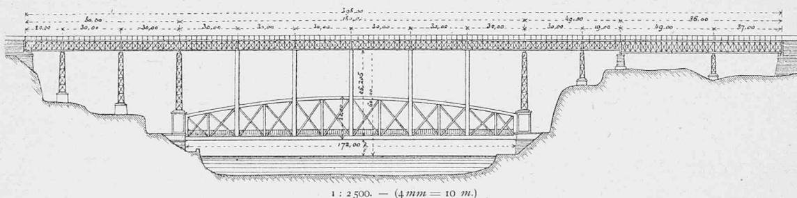
les piles de support correspondent aux suspensions du tablier inférieur. En cet endroit, les poutres n'ont que 3,50 m de hauteur; elles forment garde-corps de la chaussée. Au delà des piles-culées, les travées sont beaucoup plus grandes, ayant jusqu'à 53 m, ce qui nécessite l'emploi de poutres de 4,80 m de hauteur.
