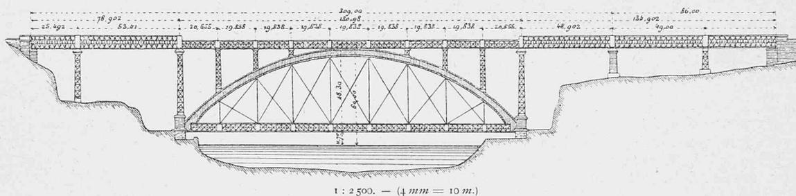
hauteur entre membrures est de 4 m. La distance entre les fermes est de 8,80 m, trop faible pour donner la résistance convenable aux efforts du vent. Elles doivent nécessairement reposer sur des appareils de dilatation dont la constitution offre de sérieuses difficultés, vu les charges énormes qui viennent s'exercer en ces points.
