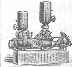
anstatt „Hydraulischer Widder“ verwendet, hat jedoch vor diesem den Vorzug, dass man mit Schmutzwasser anderes (reines) Wasser auf beliebige Höhe heben kann. — Selbstthätiger Anlauf.
