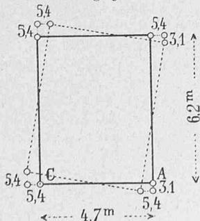
Nebenstehende Figur verdeutlicht die Formänderung, die der Endquerschnitt erfährt. Der Rahmen ist im Massstabe 1:200 gezeichnet; die lotrechten und wagrechten Verschiebungen sind in halber natürlicher Grösse aufgetragen und in Millimetern beige geschrieben. Die Figur zeigt somit die Drehung des Querrahmens in 100-facher Vergrößerung.
