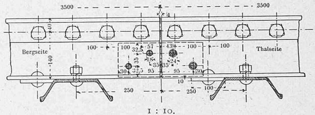
Fig. 14. Schienenstoss.
