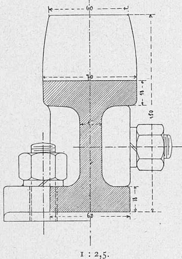
Fig. 16. Unterbrechungsstelle der Zahnstange.
