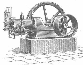
**Petroleum-Motoren** stehender und liegender Konstruktion bis 25 Pferdekraften.
