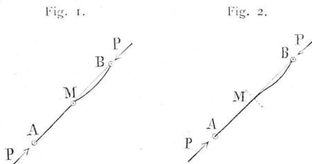
ist der Stab bei *M* durch ein Gelenk unterbrochen; der untere Teil *AM* wird durch die überwiegenden Zugkräfte in seiner normalen geraden Lage erhalten, der obere Teil *BM* biegt sich wie ein bei *B* und *M* in Gelenken geführter Stab aus. Die entsprechende Knickkraft ist annähernd
