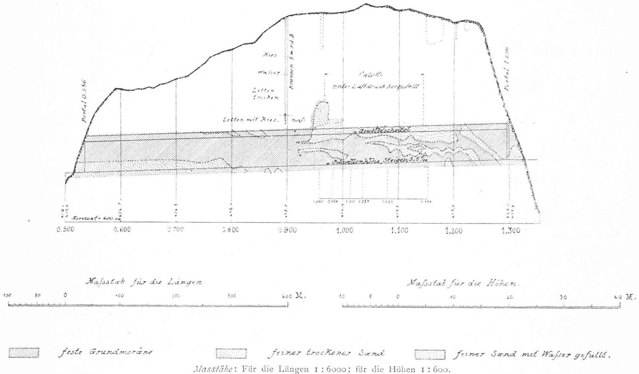
30. August bis km 1,037 gelangt war, wurde er mittelst doppelter Wand und Zwischenfüllung von Lehm dicht abgeschlossen und das Gewölbe von km 0,984 bis 1,028 am 14. Sept. fertig gestellt.
